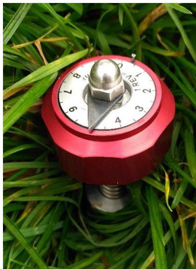
Fotografia 4. Urządzenie ścinające - pomiar wytrzymałości darni na ścinanie
