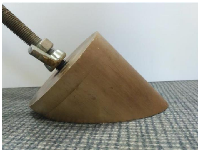
Fotografia 6. Mosiężne kopyto do pomiaru odbojności
