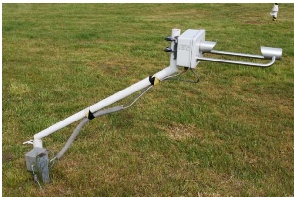
Rys. 1. a) instalacja bezstykowego deszczomierza laserowego, b) pomiar wilgotności gleby metodą TDR na terenie Wydziałowego Obserwatorium Agro- i Hydrometeorologii
