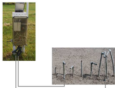
Rys. 1. a) instalacja bezstykowego deszczomierza laserowego, b) pomiar wilgotności gleby metodą TDR na terenie Wydziałowego Obserwatorium Agro- i Hydrometeorologii
